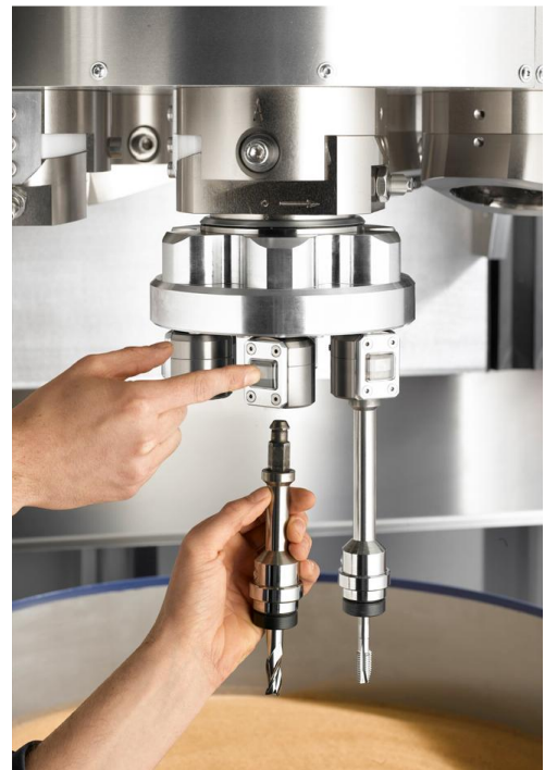
Bild 1: Werkstückwechsel auf Knopfdruck
