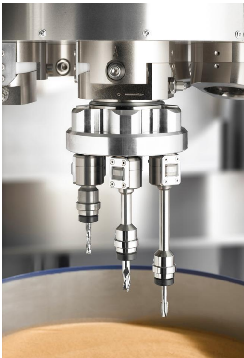
Bild 2: Werkstückaufnahmen in verschiedenen Längen
